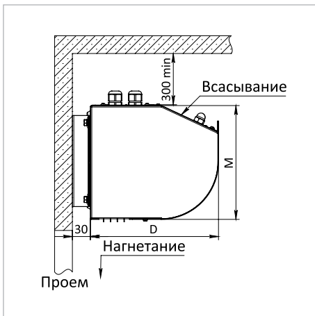
ГОРИЗОНТАЛЬНАЯ УСТАНОВКА К СТЕНЕ С ПОМОЩЬЮ КРОНШТЕЙНОВ
